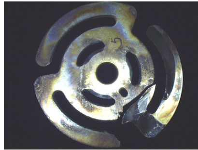
Fig.7. 흡배기벨브 스프링의 파손상태 2
