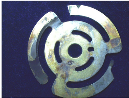
Fig.6. 흡배기벨브 스프링의 파손상태 1
