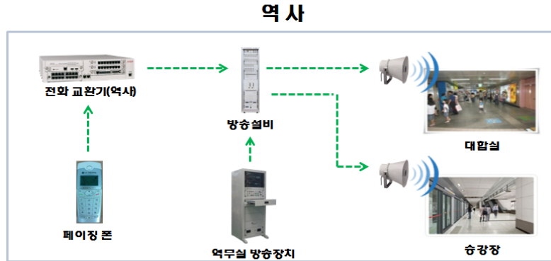
Fig. 2 기존 역사 수동방송 계통도
