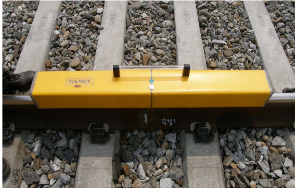
Fig. 5 레일표면 요철측정 전경
